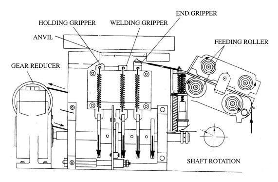
FIGURE 18. WELDING STRAP IS RELEASED; HEAD IS IN HOME POSITION; STRAP FEEDS
