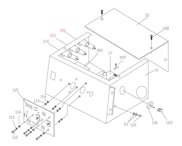
FIGURE 10-2. CONTROL BOX ASSEMBLY
