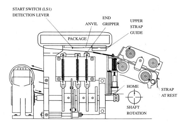
FIGURE 14. ENCIRCLING PACKAGE; TRIPPING LS1
