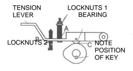
FIGURE 23. ADJUSTING TENSION LEVER
